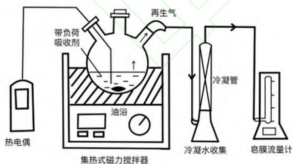
图 3 再生实验装置示意
