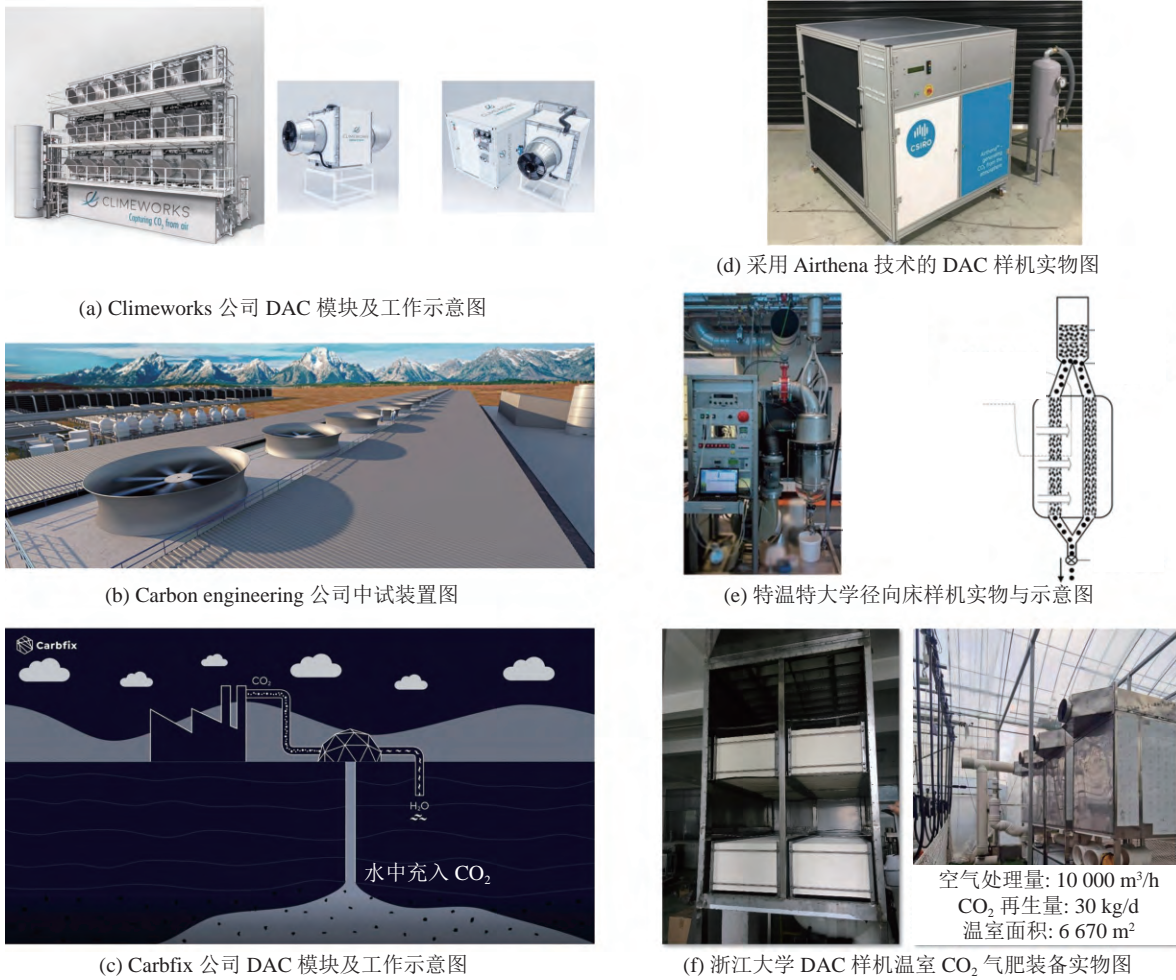
图 9 部分公司直接空气捕集示范装置或工作原理示意图
